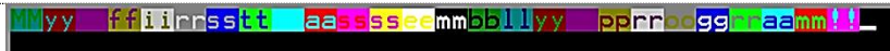
Figura 2.9. Posibilitatea afișării multiple a fiecărui caracter prin utilizarea întreruperii int 10h cu serviciul 09h
